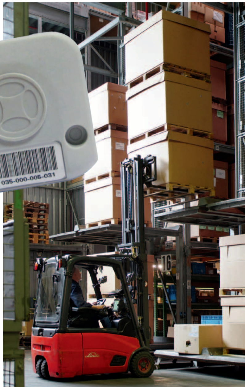
Technologie von Ubisense: Mit den Sensoren in der Halle von Herma sowie den Tags an den Gabelstaplern wird die exakte Abladeposition der Palette erfasst.
